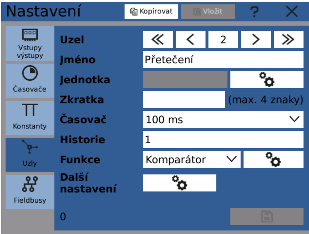
Vytvoření nového uzlu - komparátoru
