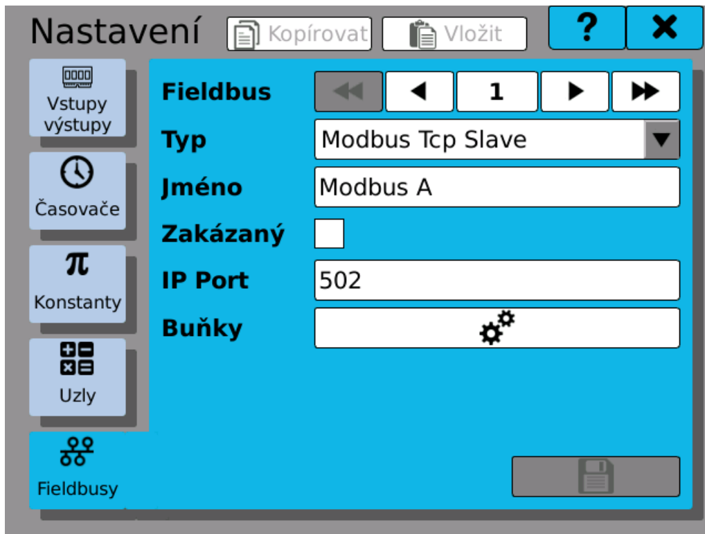
Vytváření nového fieldbusu typu Modbus TCP
