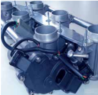
Bezkontaktní řízení škrtkicí klapky
